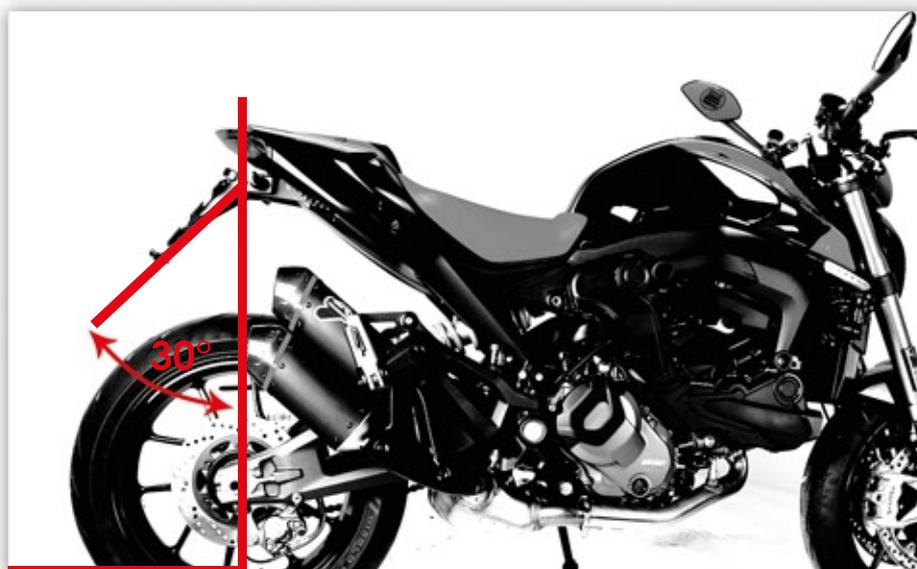
Richten Sie nun den Kennzeichenhalter so am Fahrzeug aus (Schraube A), dass er symmetrisch am Fahrzeug sitzt und der Winkel den gesetzlichen Anforderungen von 30° entspricht (siehe Bild oben).
