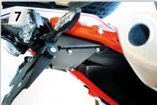
MIZU Kennzeichenhalter mit 2 x Linsenkopf-Schrauben M6 x 55 vorne und 2 x Linsenkopf-Schrauben M6 x 25 hinten sowie den Distanzhülsen an den orig. Befestigungsbohrungen am Fahrzeug anschrauben. Die Kabel für Blinker einführen. Distanzhülsen können für einfache Montage mit etwas Fett „angeklebt“ werden.
