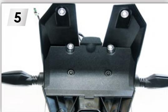
5 Die originalen Blinker demontieren. Tipp: 14er Langnuss/Stecknuss.
