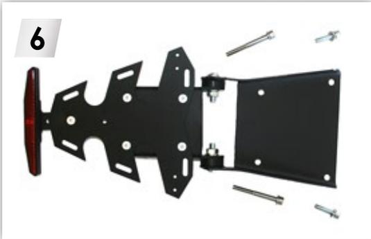
Distanzbuchsen und Blinkerhalter mit beiliegenden Distanzbuchsen an den MIZU Träger montieren.
