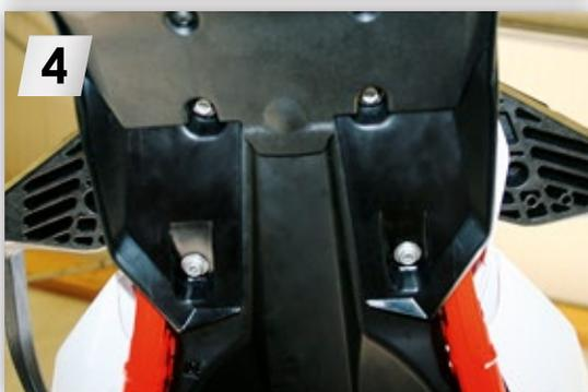
4 4 x Halteschrauben entfernen. Hinweis: die vorderen Schrauben sind links und rechts unter der Gummiabdeckung.
