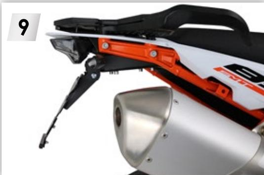
Kennzeichenträger an Grundhalterung schrauben, Blinkerhalter mit Buchsen verbinden. Nach Abschluss der Montage die Funktion der Blinker und Beleuchtung prüfen. Auf korrekte Gradzahl (30°) vom Halter achten.
