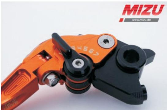
Setzen Sie den MIZU-Hebel mit der originalen Schraube und etwas Fett wieder ein und ziehen die Mutter mit einem Drehmoment von 6 Nm an.
