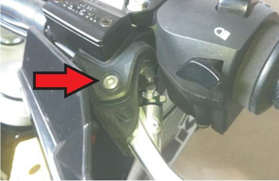
Entfernen Sie die originale Befestigungsschraube indem Sie die Mutter an der Unterseite abdrehen und anschließend die Schraube herausdrehen.
