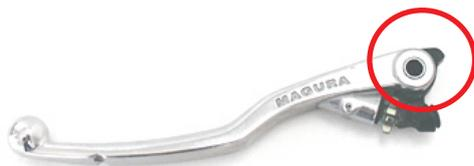
Hülse mit Hilfe eines 9 mm Dorn ausdrücken.
