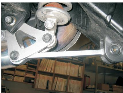
Schmieren Sie die Lagerbuchse am MIZU-Bauteil und montieren den Umlenkhebel an der Rahmenhalterung.
